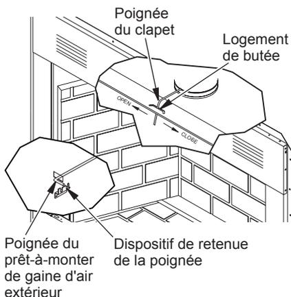
*Figure 25 - Poignets du clapet et du prêt-à-monter de gainé d'air extérieur*
