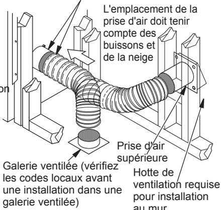
**Figure 8 - Prêt-à-monter de gaine d'air extérieur**
